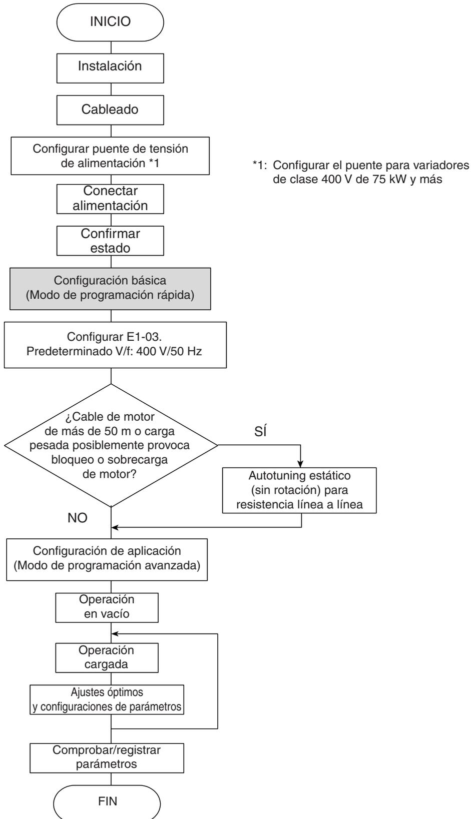
Fig. 8 Diagrama de flujo de operación de prueba
