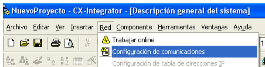
En “configuración de comunicaciones” se elige el PLC, en este caso un CP1L, y la forma de comunicación. Una vez configurado, se pone online y se configura la tabla de rutas.
