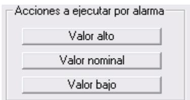
Permite la ejecución automática de una serie de acciones cuando el valor de la señal excede el rango superior, inferior o retorna al estado nominal.
