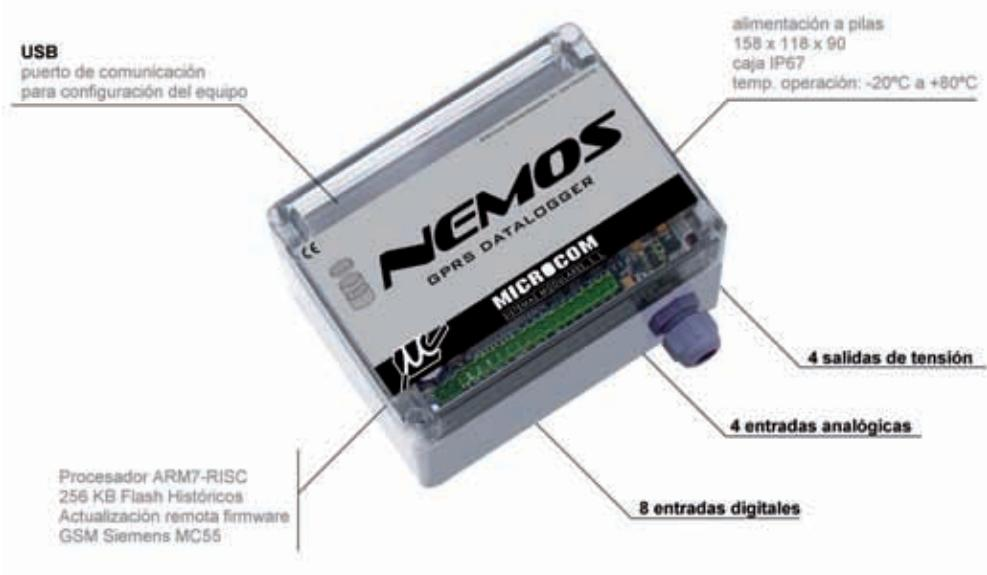
El Nemos es un registrador de datos o "datalogger" con comunicación GSM/GPRS y alimentación a pilas.
