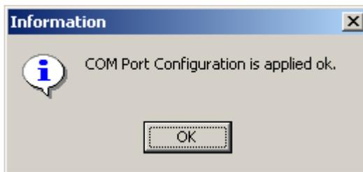
A partir de aquí, si en cualquier aplicación (CX-Supervisor, CX-Programmer, NS-Designer...) se selecciona el COM4 en comunicaciones serie, el PC redireccionará los datos al puerto Ethernet para una comunicación Wireless LAN.
