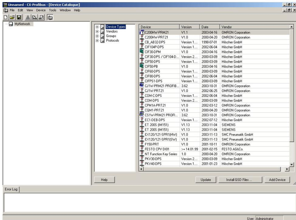
En esta ventana nos aparece un listado completo de todos los componentes que tenemos instalados en nuestro configurador. En nuestro ejemplo con la configuración por defecto, ya se adjuntan los archivos asociados a los módulos CJ1W-PRM21, CJ1W-PRT21, así como al PRT1-COM. Para añadir los dos dispositivos
