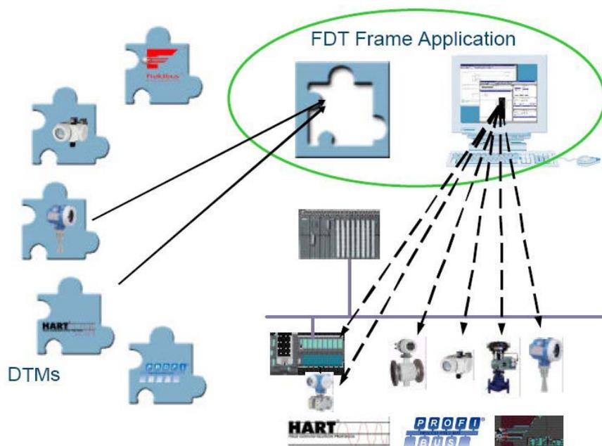
Además el concepto de FDT/DTM permite realizar funciones de diagnóstico, algo que no se soportaba con las configuraciones a través de softwares configuradores basados en el uso de ficheros GSD.
