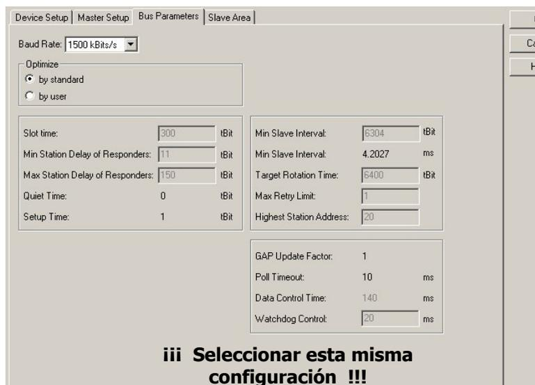
Modificar únicamente la velocidad de comunicación del bus ('Baud Rate'). El resto de parámetros no tocarlos a no ser que nos encontremos con problemas de comunicación con algún esclavo determinado. Tener en cuenta, que la distancia total del bus depende de manera directa de la velocidad seleccionada:
