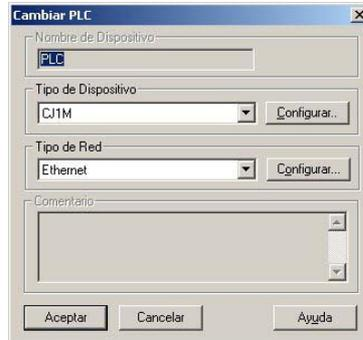
Una vez establecido el modelo de CPU, así como el modo de comunicación, seleccionar el nº de nodo y el nº de unidad de la tarjeta maestra de Profibus. Comprobar si la conexión es correcta pulsando la tecla de 'Test', nos devolverá la referencia de la unidad, así como el firmware del mismo.
