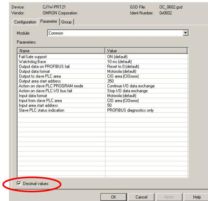
Se mantiene la configuración por defecto con un tamaño de 4 canales:
