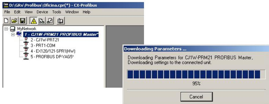
**IMPORTANTE.**- Al transferir la configuración, el software chequea el modo de la CPU, ya que la transferencia debe realizarse en modo PROGRAM. Comprobar el estado del led 'PRM' de la Unidad Maestra. Si la configuración volcada es correcta, éste debe estar fijo en verde.
