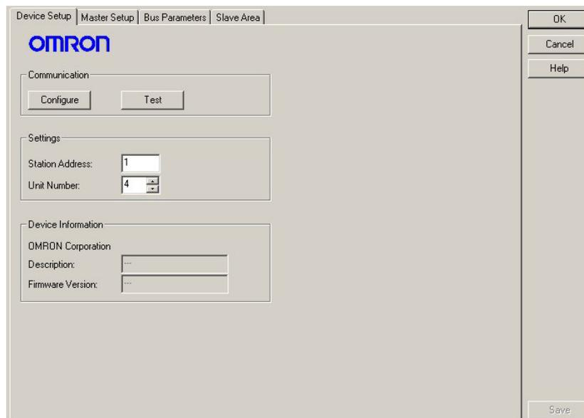
Ésta es la ventana general de configuración de la Unidad Maestra. Pulsando sobre 'Configure' se accede a la ventana de configuración de CX-Server donde se selecciona el modelo de CPU y el modo de comunicación con el PLC, para posteriormente poder transferir la configuración.
