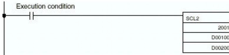
El valor de CIO 2005 es escalado de acuerdo con la función lineal calculada utilizando el offset (0000Hex), y los valores de ΔX (1068Hex) y ΔY (0315Hex). El valor de escalado es almacenado en el canal D00200.
