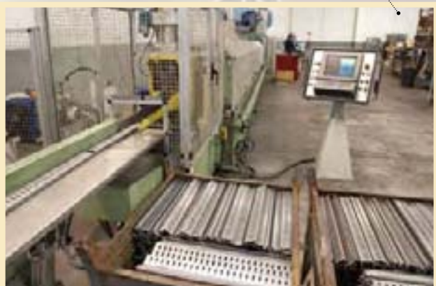
▶ Instalación para el perfilado de sistemas de suspensión y fijación Plant for forming of fixing and supporting systems
