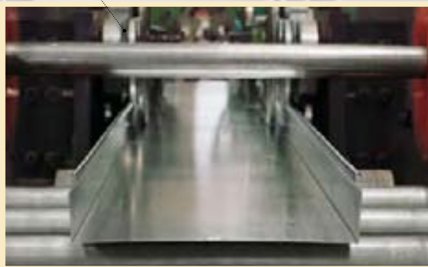
▶ Instalación para el perfilado de sistemas de suspensión y fijación Plant for forming of fixing and supporting systems
